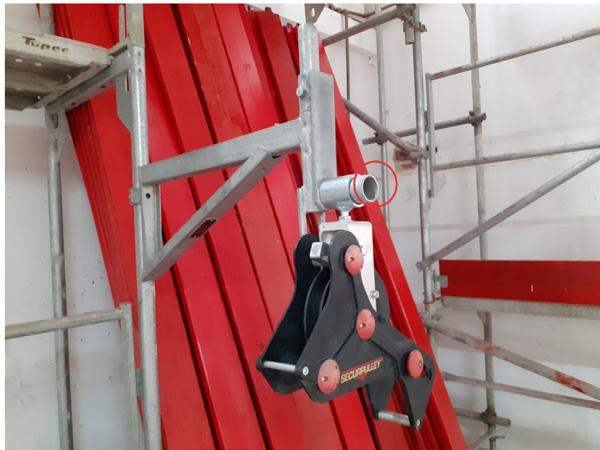
Encaixe do pino e trava pino
